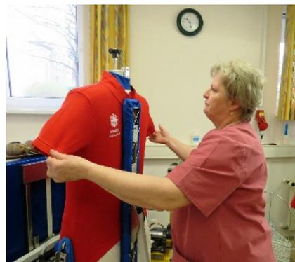
Oberteile werden über die Büste gezogen und dann mit warmer Luft und Dampf geglättet. Feste Gewebe wie Hemden und Blusen werden gespannt. Aber auch »Wirkware«, also Strickpullover, T-Shirts und Polohemden, können damit getrocknet, in Form gebracht und gebügelt werden. Dieser Vorgang dauert ungefähr vier Minuten, geht also schneller, als man es mit einem herkömmlichen Bügeleisen schafft.
